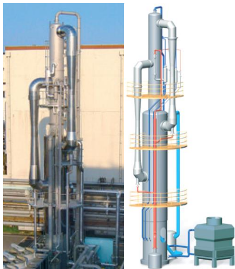
شکل 4. واحد سرمایش با جت بخار دو مرحله‌ای با طراحی ستونی جهت سرمایش 220 m 3 /hr آب از 10 تا 5°C. ظرفیت تبرید: 1163 kW
